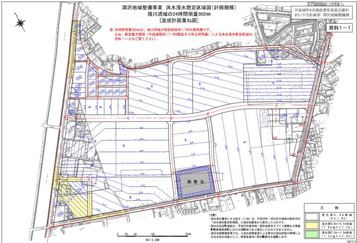
図 深沢地域整備事業 洪水浸水想定区域図(計画規模) 境川流域の24時間雨量302mm [造成計画重ね図] (出典：平成30年9月建設常任委員会資料)
