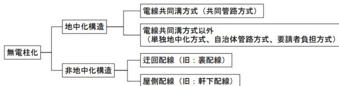
図3 無電柱化の手法※1
