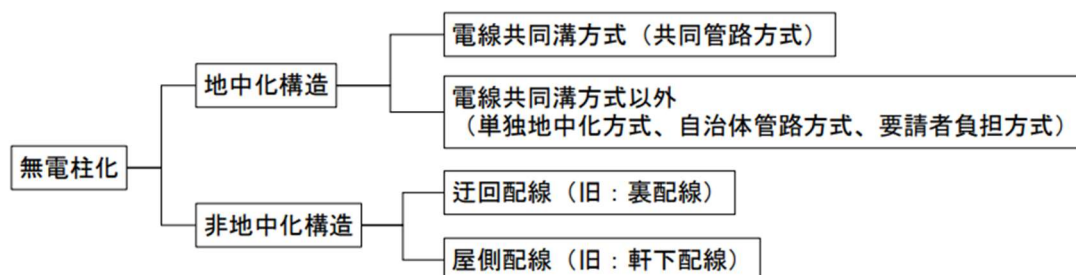
図3 無電柱化の手法※1
