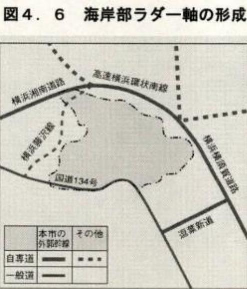
神奈川県の自動車専用道路網計画のうち、本市の交通に直接的な影響を持つ計画は、横浜横須賀道路及び逗葉新道に高速横浜環状南線と横浜湘南道路の計画を加えたネットワークです。この自動車専用道路網のうち、自動車専用道路相互が接続していない区間が、逗子～茅ヶ崎の間であり、この区間を国道 134 号で連絡することにより本市の外郭を取り巻く幹線道路網が形成できます。
