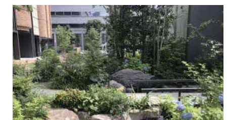
レインガーデン（雨庭）： 降雨時に雨水を一時的に貯留し、時間をかけて地下へ浸透させる透水型の植栽スペース
