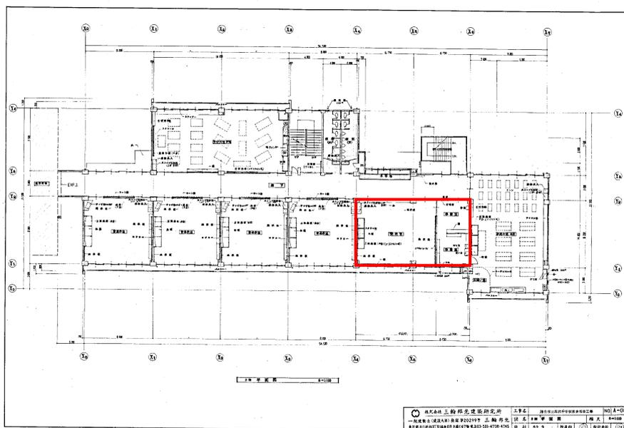
(5) 高さ 天井高 (床~天井) 2940mm、床 60mm
